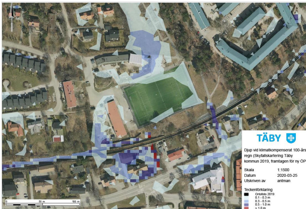
Figur 2. Utdrag från kommunens skyfallskartering som visar djupet och var vatten samlas vid ett klimatkompenserat 100-årsregn
